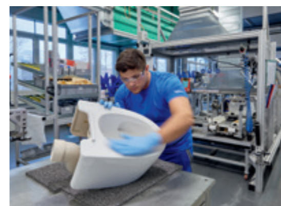
Montering av duschtoaletter...
